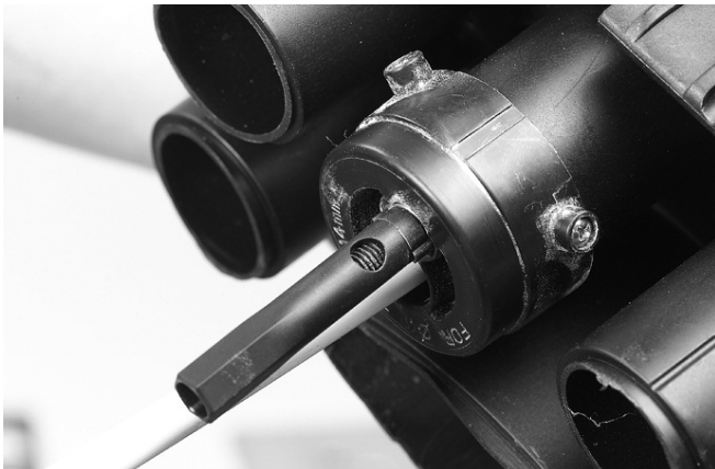
5.11.1 Spänn låsskruven för hand tills flänsarna laser.
