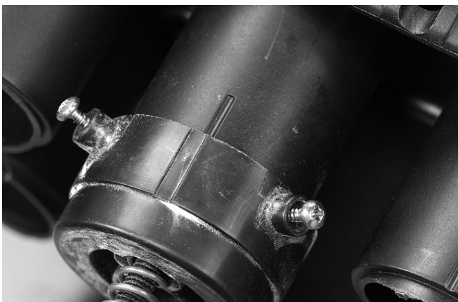
5.29.2 Montera kabelgenomföringen i den avsedd port. Strecket mellan skruvarna skall linjeras mot strecket på kabelingången. Se till att kabelgenomföringen bottnar. Strecket på kabelingången skall täckas helt av kabelgenomföringen. Tryck kabelgenomföringen mot kabelintaget/skarvboxen och skruva fast den med de två fixeringsskruvarna. Kontrollera att skruvarna fäster ordentligt i kabelintaget.
